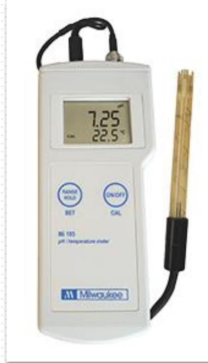
Su electrodo contiene un sensor de temperatura incorporado y un amplificador para prevenir interferencias eléctricas. La amplia pantalla muestra mediciones en un rango extendido de pH - 2,00 a 16,00 y de temperatura de -5,0 a 105,0°C o de 23 a 221°F.
